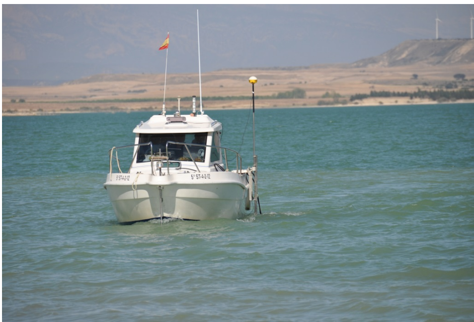
Figura 2. Trabajos de ecosondeo en el embalse de la Sotonera
