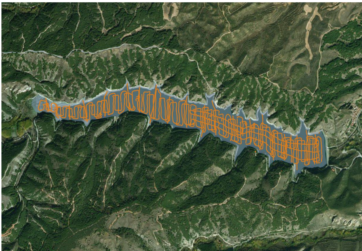
Figura 4. Distribución de los sondeos registrados y contorno del embalse durante el muestreo hidroacústico
