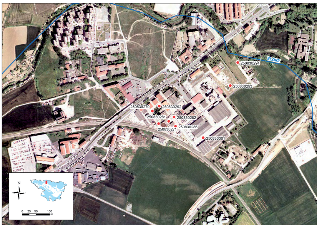
■ FIGURA 5.3.7 SITUACIÓN DE LA ZONA CONTAMINADA Y DE LOS PIEZÓMETROS DE CONTROL. ZONA 029-01
