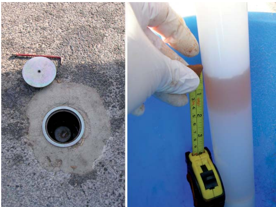
■ FIGURA 5.3.25 FASE LIBRE DE HIDROCARBURO EN EL PIEZÓMETRO 251050050 (18/01/2012). ZONA 049-03
