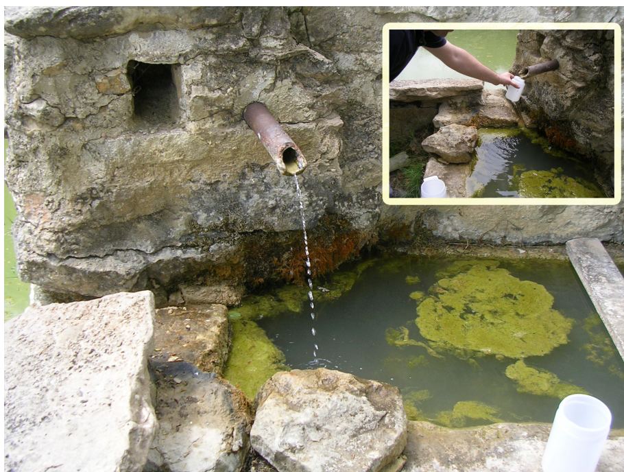
Figura 5.2.52 Muestreo del punto 292170012 MASIA DE LA ESCUELA (TTMM Cantavieja, Teruel), realizado el 07/05/2014. Concentración de \text{NO}_3^- 8,0 mg/l.
