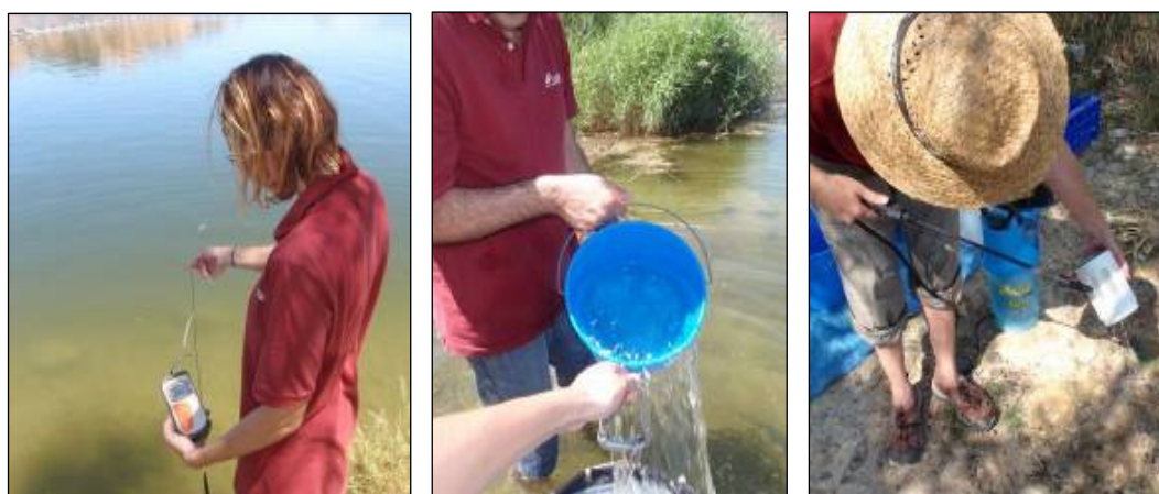
Figura 5.- Lectura de temperatura, recogida de muestras de agua del embalse y desinfección del material de muestreo (Foto: Anhidra SLP).
