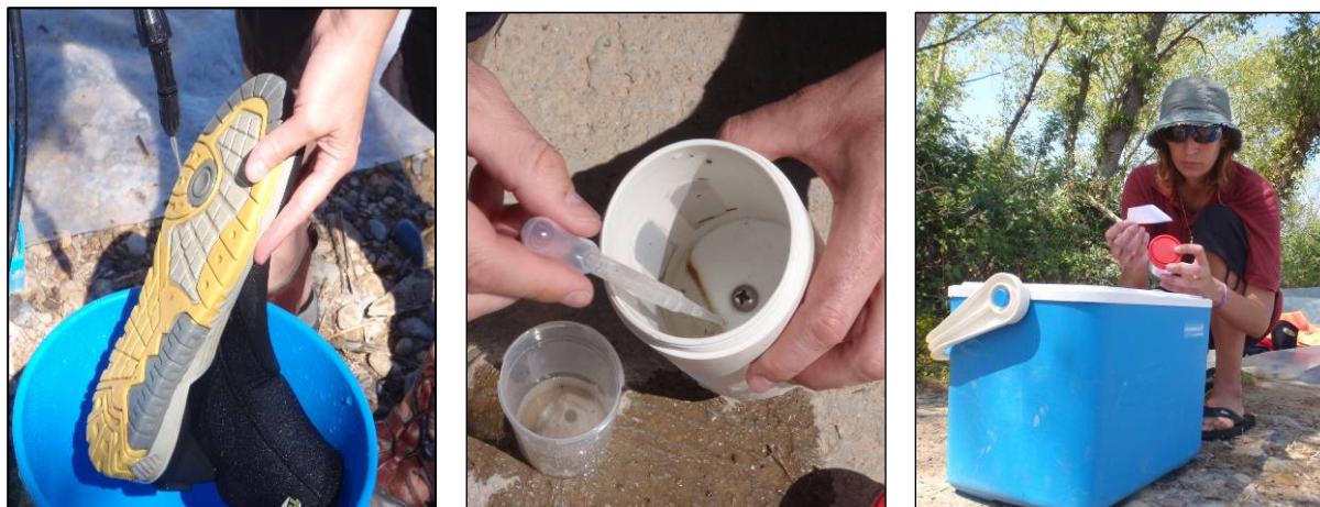
Figura 4.- Recogida de muestras: filtrado de las aguas de lavado, trasvase al recipiente estéril y etiquetado (Foto: Anhidra SLP).
