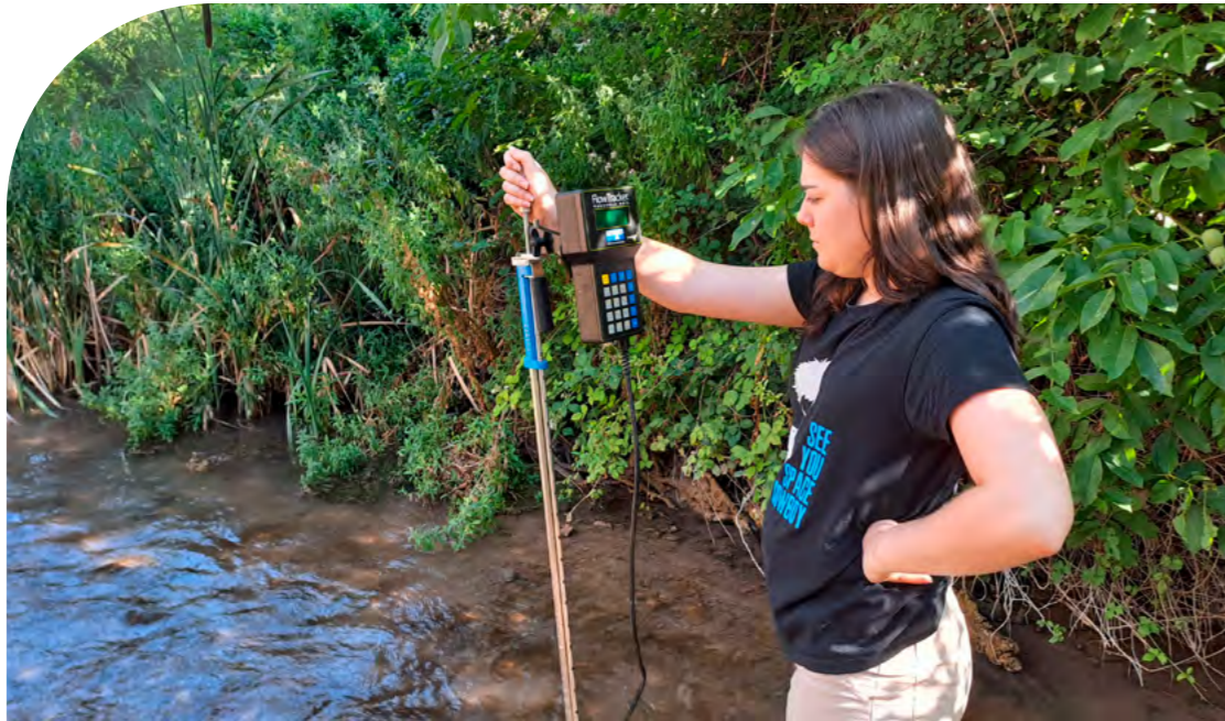
Medición de caudal con tecnología Doppler
