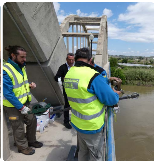
Toma de muestras de sedimento en suspensión. Puente de Mora de Ebro. 5 de mayo de 2022.
