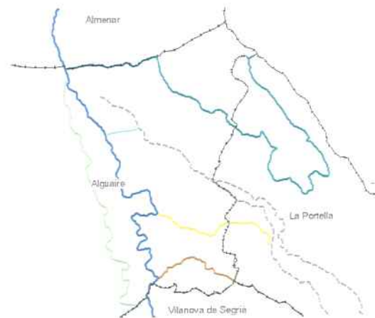
Figura 1.8.32. – Ramals del Canal Principal (blau fort) anomenats Séquia de Ratera (verd fort), braçal major (verd fluix), presa 130 de Corbins (blau cel), Ull de Cruells (groc) i l'Ull del Xop (marró).
