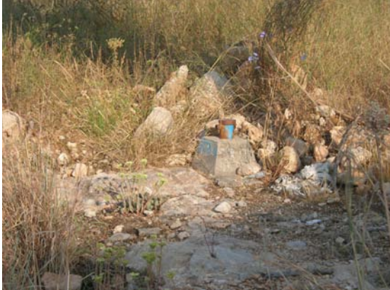
Piezómetro en Alcanar controlado por la CHE. Fuera del ámbito de la cuenca del Ebro, caracteriza las descargas del acuífero mesozoico hacia la costa.
