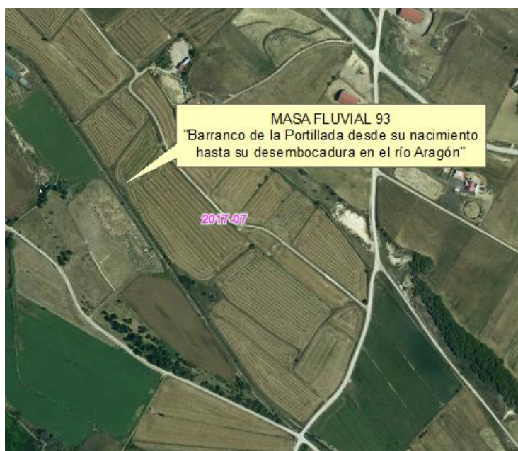
Figura 20. Propuesta de cambio de naturaleza (de natural a muy modificada) de la masa tipo río ES091MSPF93 en el Barranco de la Portillada (detalle del tramo final, rectilíneo y canalizado).
