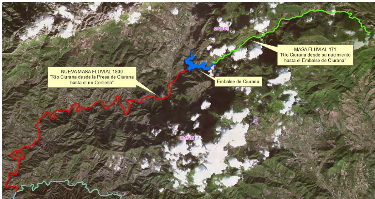
Figura 22. Discontinuidad cartográfica de la masa tipo río ES091MSPF171 en el río Ciurana. Se propone dividir la actual masa en dos: ES091MSPF171, desde nacimiento hasta el embalse de Ciurana, y ES091MSPF1800, desde la presa de ese embalse hasta el final
