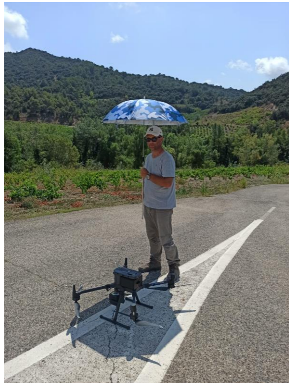
Imagen 2.1.5 RPAS Matrice 300 RTK con cámara L1, debido al calor de agosto, para evitar sobrecalentamientos se sombreaba
