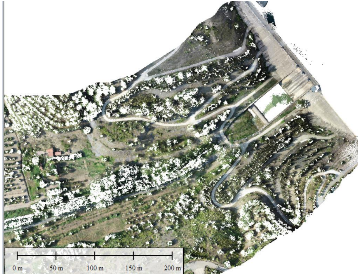
Imagen 3.1.2 Filtrado de arbolado y construcciones para DTM
